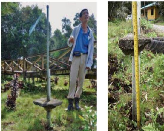
Gambar A3.1: Contoh penurunan muka tanah tiang dipasang
