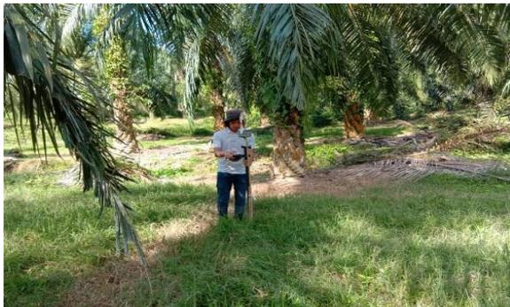
Gambar A5.5: Pengukuran ketinggian *spot* menggunakan GPS Rover
