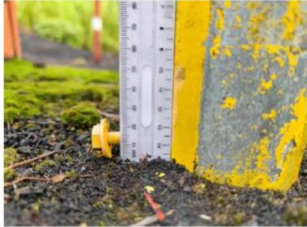
Gambar A3.3: Foto menunjukkan aturan pengukuran untuk membaca penurunan tingkat.
